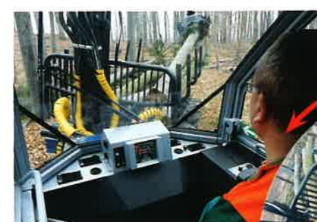
180度回転し、人間工学的に設計された機能的なキャビン広範囲な視界を提供
