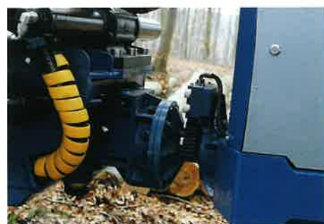
クレーン操作時の揺れを防ぐ油圧式スタビライザー (オプション)
