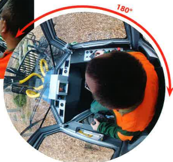
180度回転し、人間工学的に設計された機能的なキャビン広範囲な視界を提供
