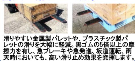
滑りやすい金属製パレットや、プラスチック製パレットの滑りを大幅に軽減。黒ゴムの5倍以上の摩擦力を有し、急ブレーキや急発進、坂道運転、雨天時においても、高い滑り止め効果を発揮します。
