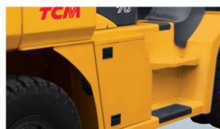
DOC・DPFマフラーを右側ステップの後方に移設し、点検カバーを設置。点検・整備も容易です。
