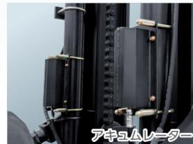
路面からの振動、衝撃によるリフトシリンダー圧力変動を高圧用、低圧用2つのアクキュレーターで吸収し緩和。騒音と衝撃を低減する、オペレーターにも、現場・周辺環境にも、積荷にもやさしい、当社独自システムのオプション装備です。
