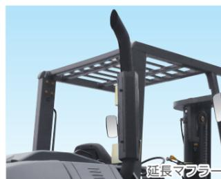
アップライトマフラーの位置を右後方に配置し排気口を外側に向けてすることで、後進時に排出ガスがオペレーターにかかりにくい配置に改良しました。さらに排気口の位置を300mm延長と500mm延長の2種類をオプションでご用意しました。
